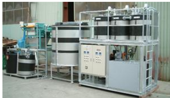
塗装前処理ユニット式廃水処理設備(処理能力: 1m 3 /hr)
